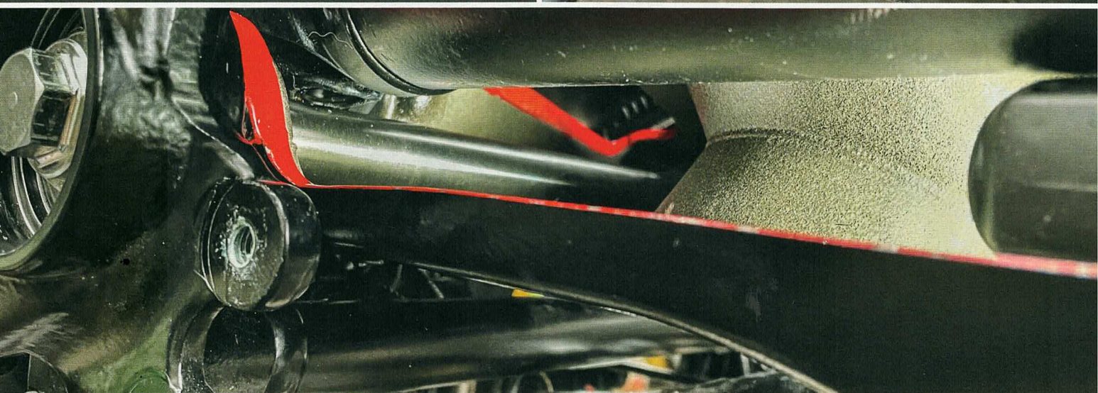
Ganz oben links die Schwingenachse vor dem Einbau, rechts das Endergebnis. Darunter die aufgeschnittene Schwinge, in der oben die Kardanwelle verläuft und darunter die von Schwarz und Widmann gefertigte, durchgehende Achse für die Schwinge. Die wird in spielfreien Lagern gehalten, deren Anlage gespiegelt wurde. Die Schwinge sitzt nun spielfrei gelagert und ohne zu verkanten im Rahmen. Ganz unten Emil Schwarz, Erich Zimmermann, Jürgen Widmann (von links)
