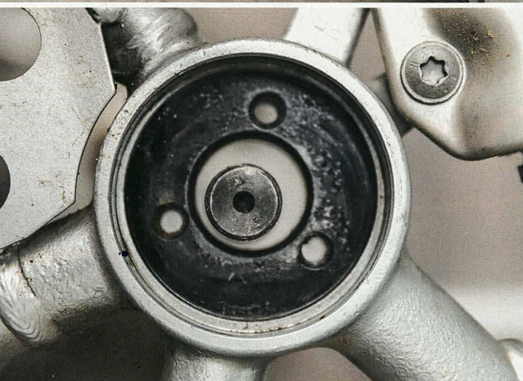
Emil Schwarz (links) und Jürgen Widmann nehmen sich der GS 1250 Adventure von Erich „Bonsai“ Zimmermann an, der in vier Jahren rund 480 000 Kilometer gefahren ist. Die unteren Bilder zeigen die Schwingenaufnahme links an einer älteren 1200er, rechts an der 1250er GS. Links wurde die Schwingenachse eingesteckt, um den Versatz der Aufnahmen für die Lagerzapfen zu zeigen. Rechts oben Originalzapfen am Kardanlager mit vier hundertstel Millimeter Spiel
