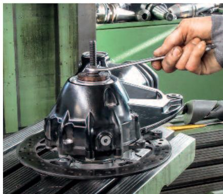
**Vorbereitung zum Lagertausch: Fixieren des Hinterachsgehäuses mit einer Spannvorrichtung**
