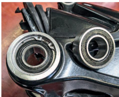
Am Paralevergelenk der Einarmschwinge: das zweireihige Original-Kugellager, einmal eingebaut, daneben noch einmal ausgebaut das gleiche Teil
