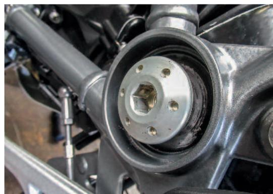
Hier noch original: der Schwingenlagerbolzen auf der linken Seite des Rahmens. Zwei bis drei Hundertstel Millimeter Spiel sind hier ab Werk normal
