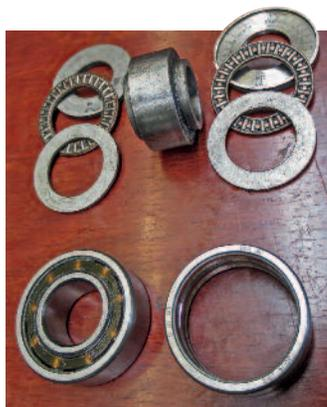
Oben: beidseitige Axial-Nadellager und Lager-Innenring. Unten: zweireihiges Original-Kugellager
